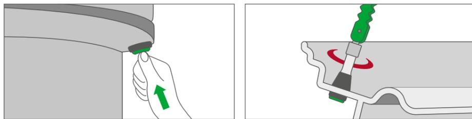
Das Ventil mit wenig Kraftaufwand von Hand eindrücken. Oder mit dem ALLIGATOR Standardeinziehhebel behutsam montieren. Einziehen des Ventils muss in axialer Richtung zum Felgenloch erfolgen - nicht verkanten.
