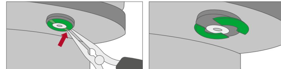
Zur Demontage mit einer Zange oder Schraubendreher, die patentierte Druckscheibe an der gekennzeichneten Sollbruchstelle anknacken und entfernen.
