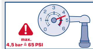
HINWEIS Gummiventile können bis zu einem Druckbereich von 4,5 bar genutzt werden
