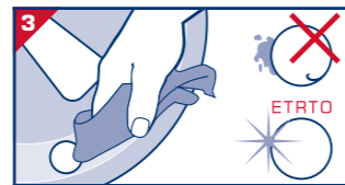
Das Ventilloch muss frei von Schmutz und Graten sein und muss der ETRTO entsprechen
