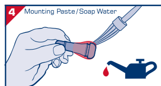
Ventil mit Seifenwasser oder Montagepaste einstreichen um Beschädigungen zu vermeiden
