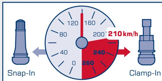
Maximal zulässige Geschwindigkeit für Snap-In Ventile beträgt 210 km/h. Für höhere Geschwindigkeiten (Index V, W, Y, ZR) müssen aus Sicherheitsgründen Metallventile verwendet werden.
