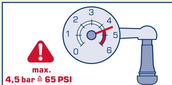
Gummiventile können bis zu einem Druckbereich von 4,5 bar genutzt werden
