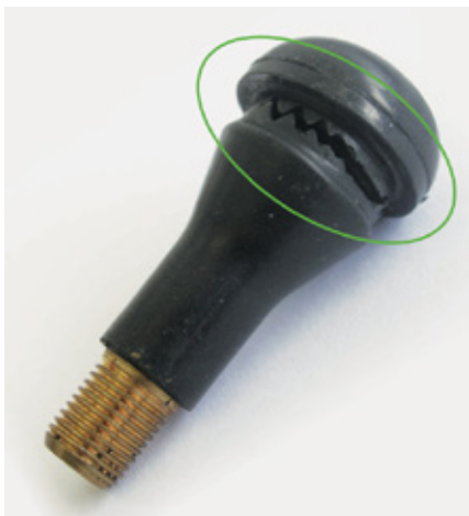
Überaltertes, abgerissenes Ventil
