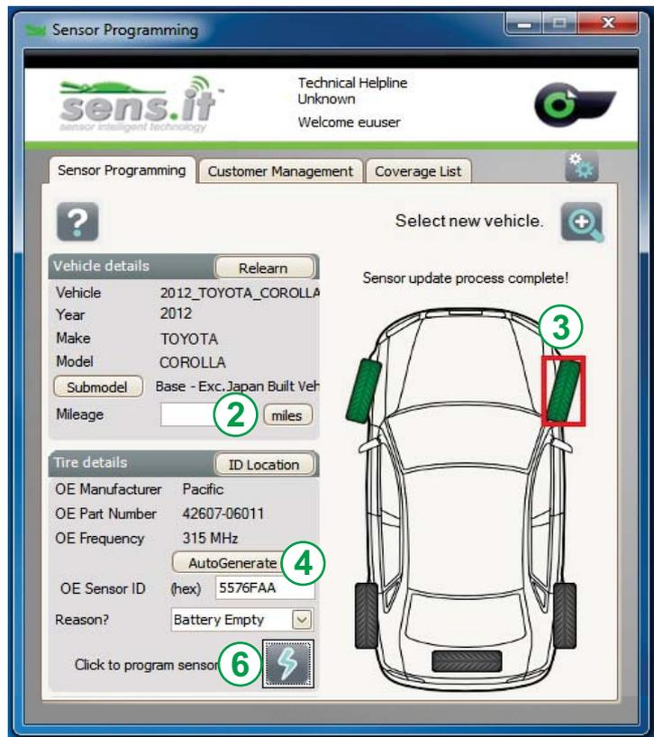
**WARNUNG!** Während der Programmiervorgang läuft, darf der Sensor nicht vom Programmiergerät genommen oder berührt werden, da sonst eine Unterbrechung im Programmiervorgang möglich ist oder die Software fehlerhaft übertragen wird. Die erfolgreiche Programmierung des Sensors wird auf dem Bildschirm angezeigt. Sie können nun einen neuen Programmiervorgang starten, entweder für das gleiche Fahrzeug ③ oder für ein neues Fahrzeug ①.
