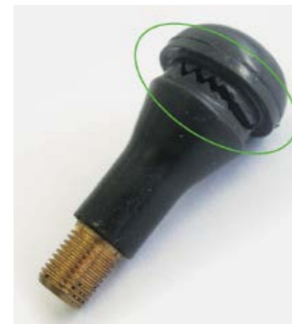
Überaltertes, abgerissenes Ventil
